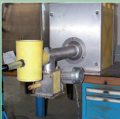
Microdoseur implanté sur doseur grand débit pour une précision accrue du batch
