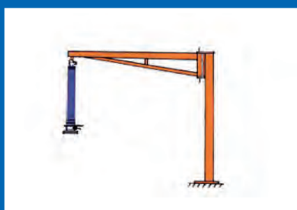
Potence inversée sur fût pivotante
