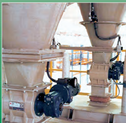
Ecluses sous silos
