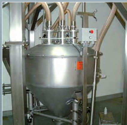
Trémie de transfert sous vide avec pesée pour introduction dans des fondoirs
