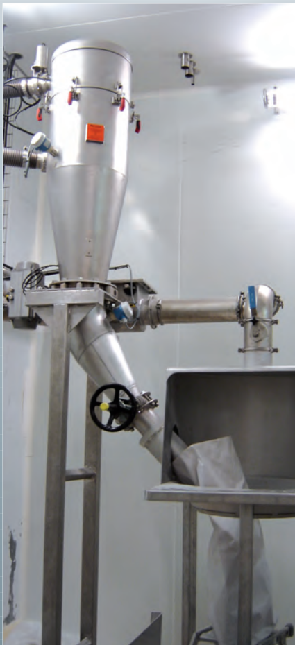
Skid de poudrage avec gestion des pesées et purge de ligne
