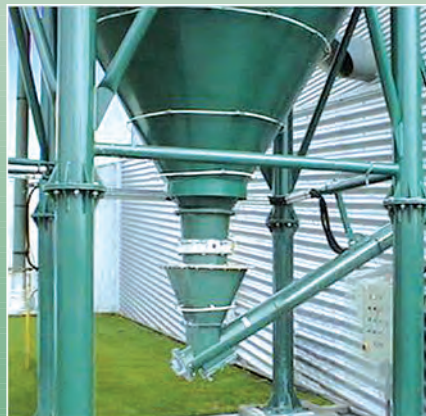
Vanne sous silo
