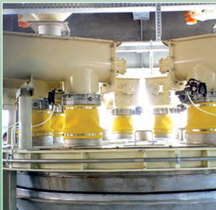
Vanne en bout de vis pour optimisation de dosage
