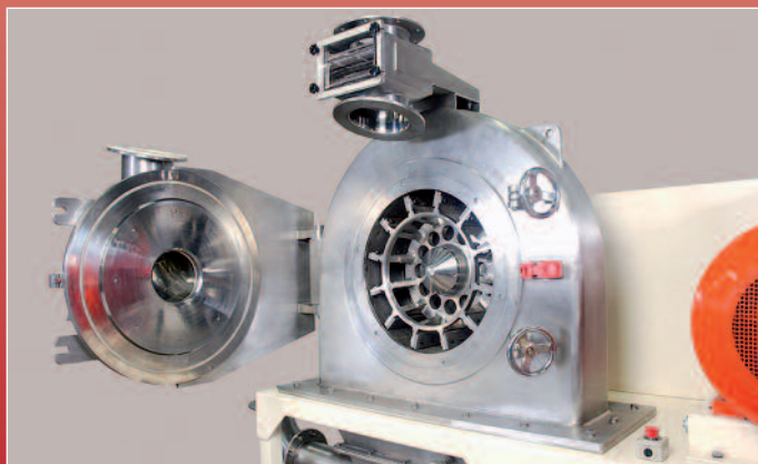
Broyeur à pales implanté en ligne sur un transfert pneumatique. Dans cette configuration, le broyeur assure le transfert du produit jusqu'à un cyclofiltre de séparation
