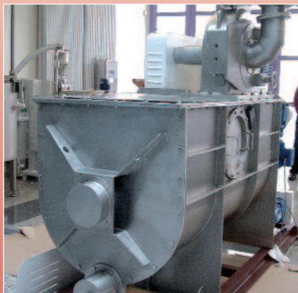
Broyeur à sucre implanté sur une cuve agitée
