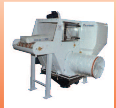
Déssacheuse avec compacteur de sacs intégré
