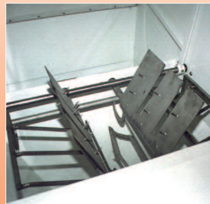
Parties mobiles internes assurant le secouage et l'éjection des sacs
