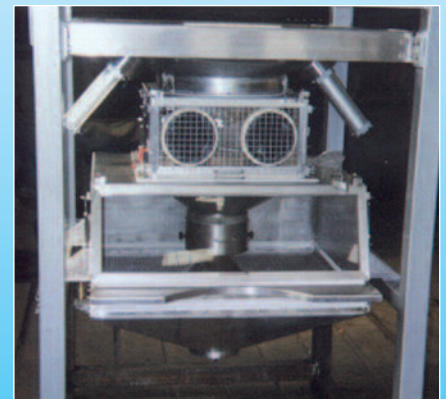
Ensemble équipé de massage du big bag et d'une boîte à « gants »
