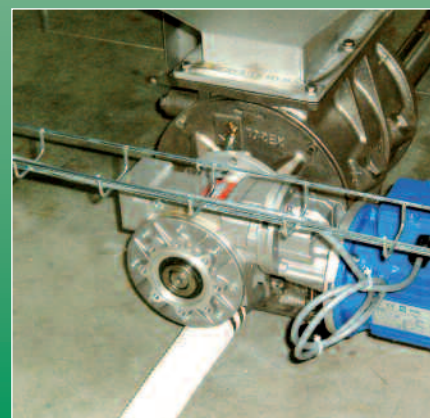
Écluse tout inox pour transfert pneumatique de granulés plastiques en sortie de silo de stockage
