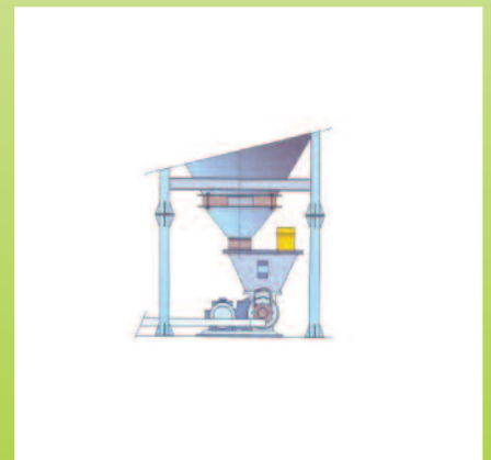
Trémie avec écluse rotative pour transfert pneumatique
