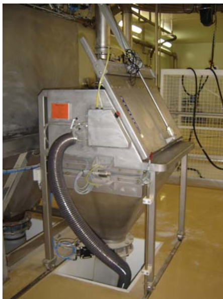
► Une des trémies vide-sac et son système d'aspiration de poussières / One of the bag slitting hoppers with its dust extraction system (doc. PALAMATIC).
