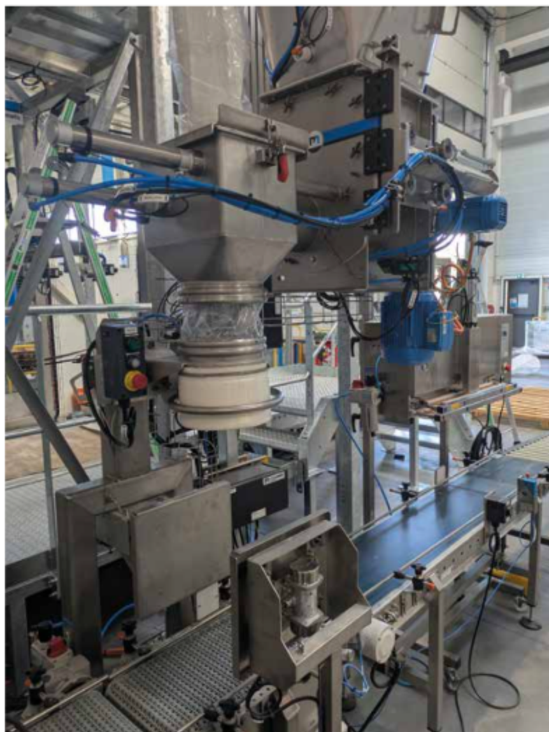
La solution conçue par Palamatic Process permet un double conditionnement : en big-bags, et en cartons.
