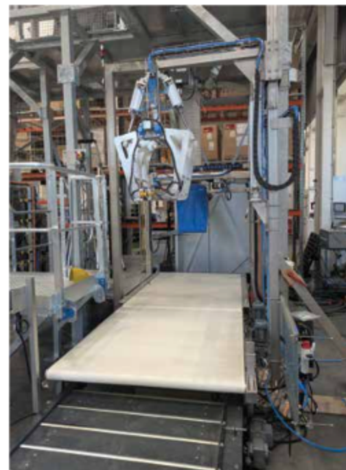
L'évacuation du big-bag est effectuée via un convoyeur à bande intégré.
