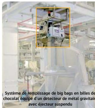
Système de remplissage de big bags en billes de chocolat équipé d'un détecteur de métal gravitaire avec éjecteur suspendu
