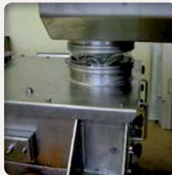
Manchette de connexion entre vis et tamiseur
