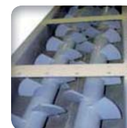
Auto-nettoyage des rotors grâce au montage sécant
