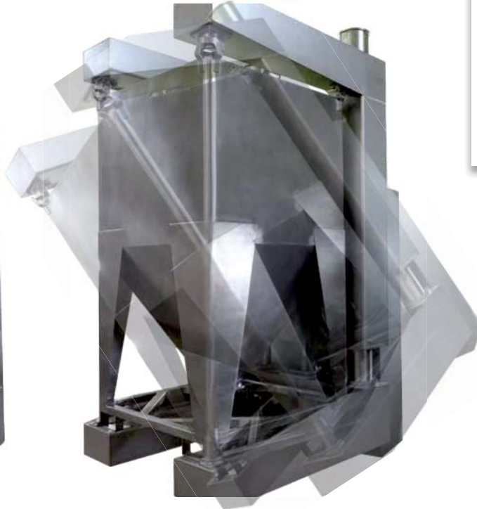
➤ Mise en rotation du conteneur
