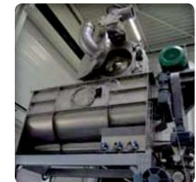
► Mélangeur intégré sur une ligne complète de broyage et d'ensilage
