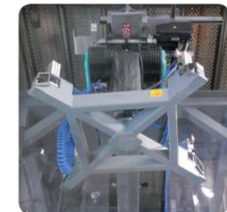
▶ **Chargement automatique :** pilotage du palan par cellule et crochet peseur
