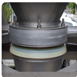
▶ Joint tulipe pour assurer un confinement et permettre des débits importants
