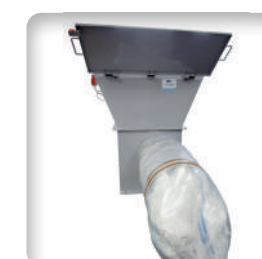
Sache de confinement 100 % étanche, environnement de travail propre, possibilité de récupération des fines résiduelles par tirage spécifique
