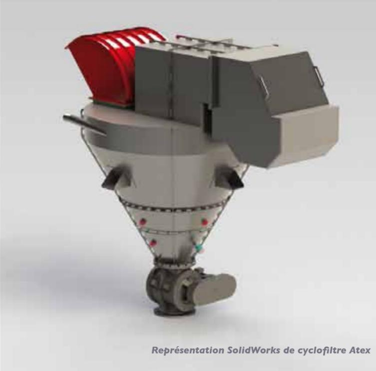
Représentation SolidWorks de cyclofiltre Atex
