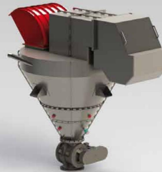
Représentation SolidWorks de cyclofiltre Atex pour la poudre d'Amidon
