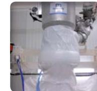
Joint gonflant pour l'étanchéité de la connexion
