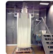
▷ **Structure suspendue** pour faciliter le nettoyage au sol
