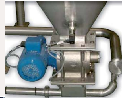
➤ Accès facile aux parties mécaniques internes pour un nettoyage aisé
