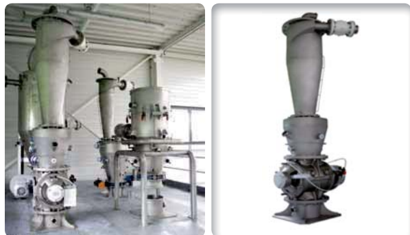
Application sous filtre pour assurer l'étanchéité et l'évacuation des fines aspirées
