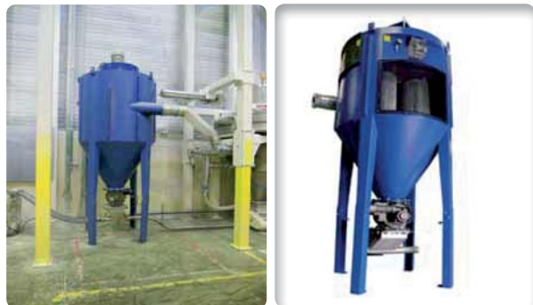
Application sous filtre pour assurer l'étanchéité et l'évacuation des fines aspirées
