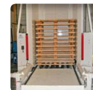
➤ Dépilleur d'une capacité de 15 palettes multi-format
