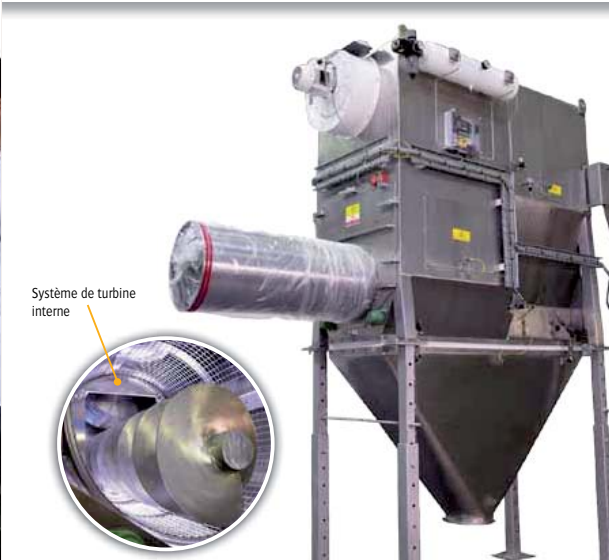
➤ Compacteur à vis pour l'évacuation des sacs vides et la réduction de l'émission de poussières
