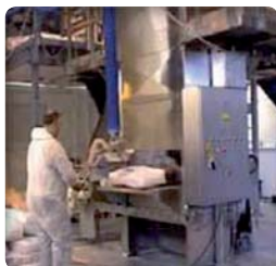
▶ Alimentation de la machine par manipulateur
