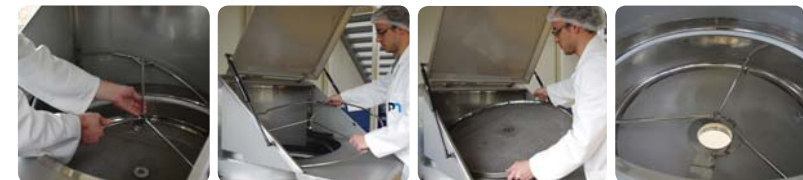
Nettoyage et changement de la grille en moins de 2 minutes.
