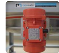
Moteur vibrant pour améliorer l'amplitude et l'intensité du tamis. Ces paramètres sont réglables en fonction de la coulabilité du produit et de la maille
