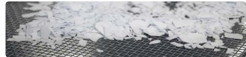
Tamis intégré : protection contre les corps étrangers pour une production vierge de toute impureté.
