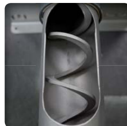
▶ Doseur à vis pour une haute précision de dosage
