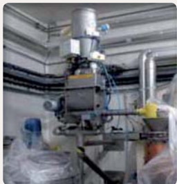
Cyclone de transfert avec un système de dosage
