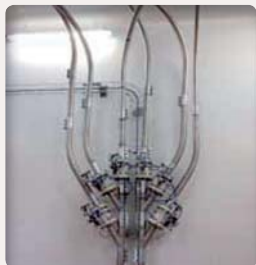
Multilignes pour l'alimentation du cyclone pesé ; permet la réalisation du prémix durant la phase de transfert.
