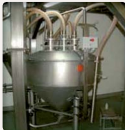
Transfert pneumatique par aspiration avec une balance intégrée « gain de poids ». Ce modèle est spécialement conçu pour l'aspiration des multi-composants.
