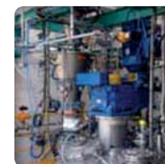
Implantation dans les environnements difficiles : alimentation de réacteurs en zone explosive; protection du filtre des remontées de vapeurs, certification ATEX zone gaz et poussière
