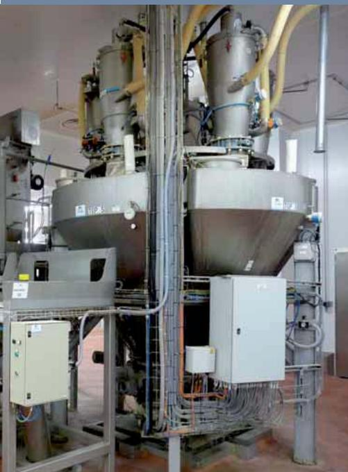
La technologie du transfert pneumatique aspiré permet d'intégrer des solutions de pesage.
