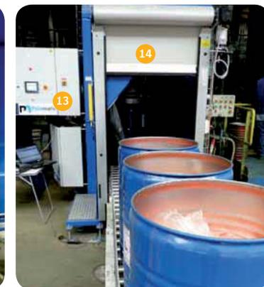
1. Enceinte de confinement - 2. Vibreur d'aide à l'écoulement - 3. Vérin de coiffage - 4. Gants pour ouverture du fût - 5. Chaise de basculement - 6. Vibreur fond de fût - 7. Convoyeur motorisé de préparation du fût - 8. Vanne de vidange - 9. Joint gonflant de connexion - 10. Groupe de basculement motorisé - 11. Vanne d'isolement de la trémie collectrice - 12. Trémie collectrice - 13. Panneau de contrôle - 14. Cabine avec porte sectionnelle
